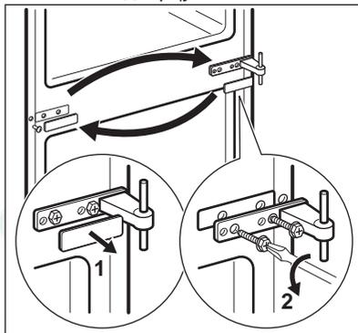
7. Снимите крышку и заглушки нижней петли, а затем отвинтите скобу нижней петли.
