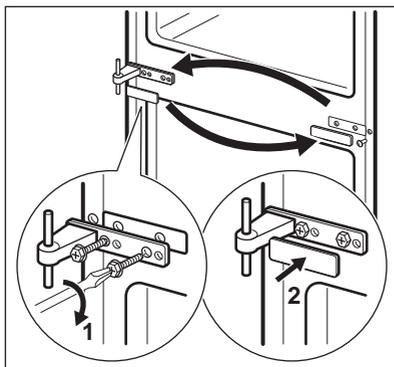
11. Снимите верхний ограничитель и установите его на противоположной стороне.
