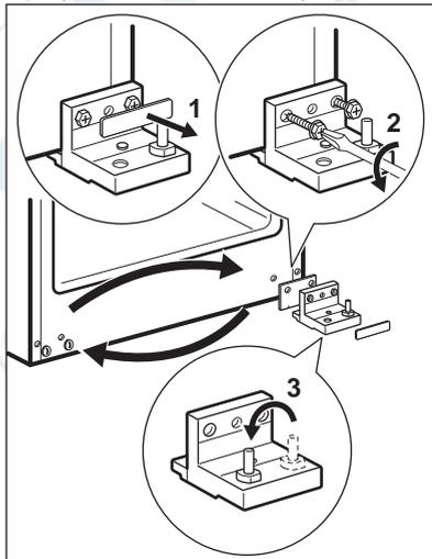
9. Установите скобу средней петли на противоположной стороне прибора.
