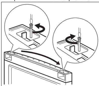
12. Снимите нижний ограничитель и установите его на противоположной стороне.
