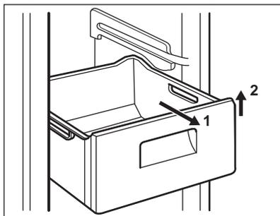
Вставляя корзину в морозильную камеру, слегка приподнимите ее переднюю часть. Преодолев стопоры, задвиньте корзину до упора.
