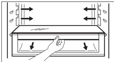
Ящик предназначен для хранения таких свежих продуктов, как мясо, рыба, морепродукты, поскольку температура в нем ниже, чем в остальной части холодильника.
